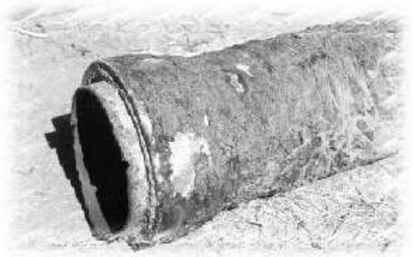
tubería de alcantarillado sanitario instalada en el centro de la ciudad de más de un siglo de antigüedad.
